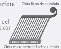
6. Encinte los alveolos de arriba con cinta de aluminio solida (previene la entrada de aire, polvo suciedad, insectos y agua al interior de los tubos.) y los alveolos de abajo con cinta de aluminio ventilada.
