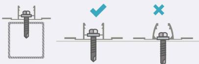
5. En caso la placa se performe es recomendable hacer perforaciones ovaladas con un diámetro mayor del tornillo y hermetizarlas con Gorillas o Arandelas de EPDM para evitar filtraciones.
